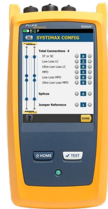
Figure 17 – le CertiFiber® Pro présentant la calculatrice des performances des fibres SYSTIMAX
