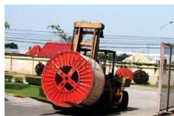
Figure 50: décharger une bobine perpendiculairement
