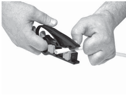
Figure 60: Outil de dénudage pour la préparation du câble
