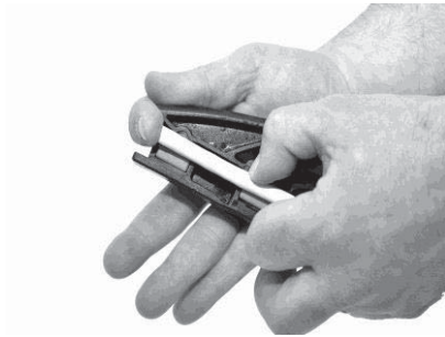
Figure 59: Distance de dénudage pour la préparation du câble
