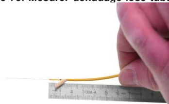
Figure 75: Mesurer dénudage lose tube ou tight buffer
