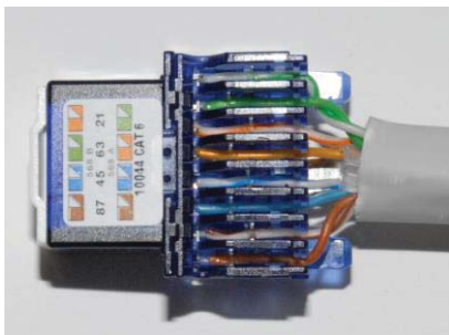
Figure 63: Câblage correct / torsion supplémentaire sur les 2 paires extérieures / Pas de croisement
