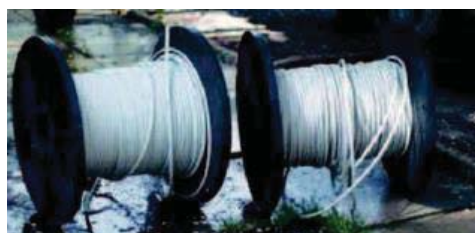
Figure 48: câble cuivre stocké à l'humidité
