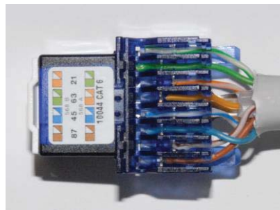
Figure 64: Câblage incorrect / Espace entre les paires / chevauchement des paires / Entrée insuffisante de paires (orange)
