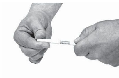
Figure 62: Dénudage du câble
