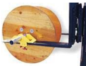
Figure 49: décharger une bobine avec une barre
