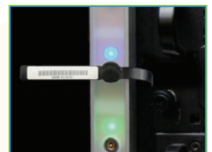
Capteur de gestion des ressources (AMS)
